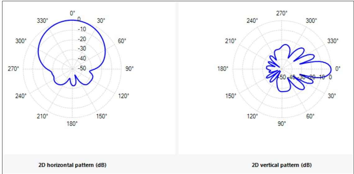
Abbildung 4.3: Antennendiagramm einer Sektorantenne
