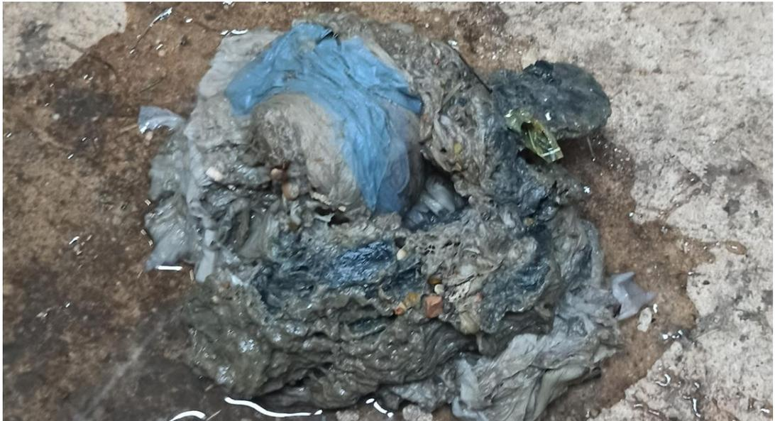
Abbildung 5-6: Entfernter Abwasserzopf der Pumpstation Egelsee
